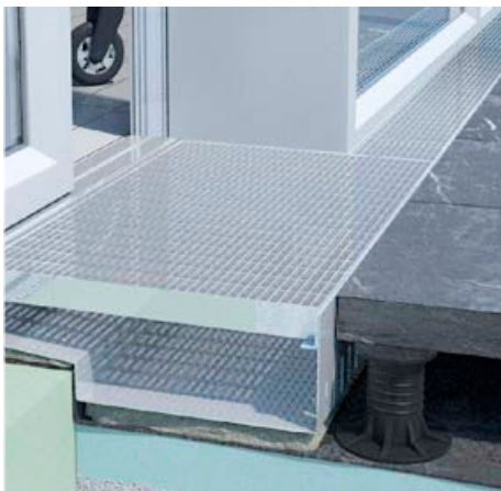
Typ ino 610 und 611 KR eingekantete Rostauflage mit glatte Aussenwänden. Rinne mit seitlicher Auskrägung vor Türen zur Überbrückung der Perimeterdämmung.
