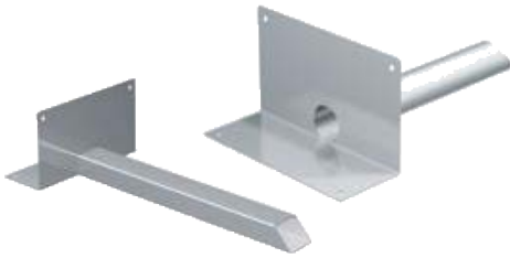
Wasserspeier aus Edelstahl mit abgewinkeltem Klebeflansch zum Aufkleben der Abdichtungsbahn. Angeschweißtes Ablaufrohr, rund wahlweise rechteckig, mit Auslaufseite abgeschragt.
