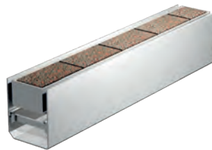
Befahrbare Rinne mit Steinkasten für mittige Pflasterreihe und beidseitigen Einlaufschlitzen Steinkasten ausgelegt für dicke Pflasterstärken zur Belastung mit Fahrverkehr bis Klasse C 250.
