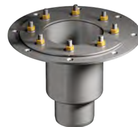
Durchführungselement für die Abdichtungsebene oder Ablaufkörper mit Pressdichtungsflansch 6/6 mm nach EN DIN 18195, bzw. DIN 18532 – 18534
